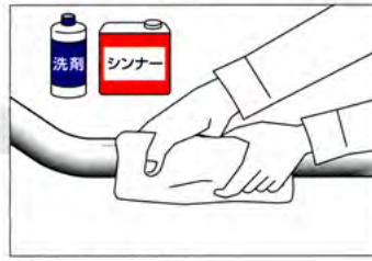
②手すりの清掃 標示板を貼り付ける手すり部分の ゴミ、ホコリ、水分、油分などをよく落と し表面を清掃する。
